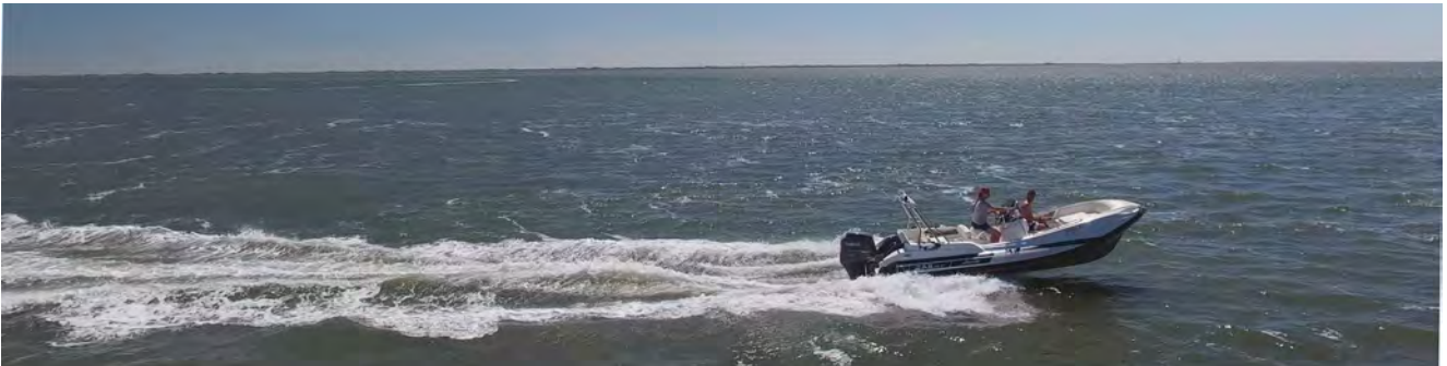
Ein RHIB der CE-Kategorie "B" vor der NF-Küste; zertifiziert für Windstärke 8 und 4m hohen Seegang
