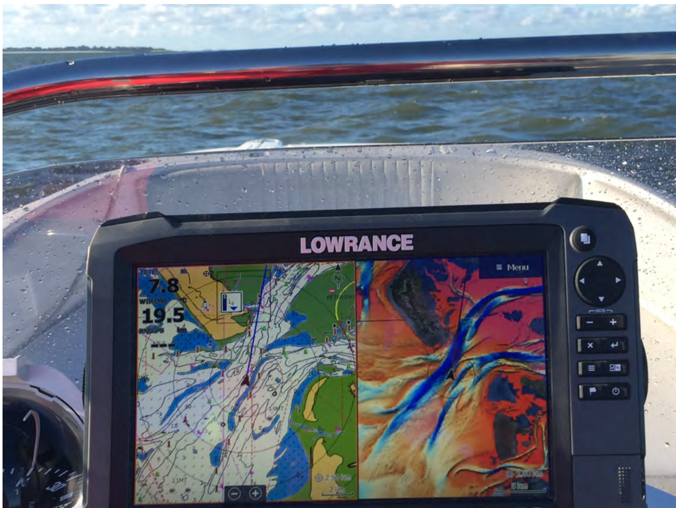
Plotter mit gleichzeitiger Darstellung von Seekarte und bathymetrischer Karte
